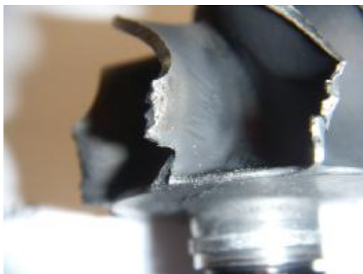
Turbine d'échappement endommagée.
